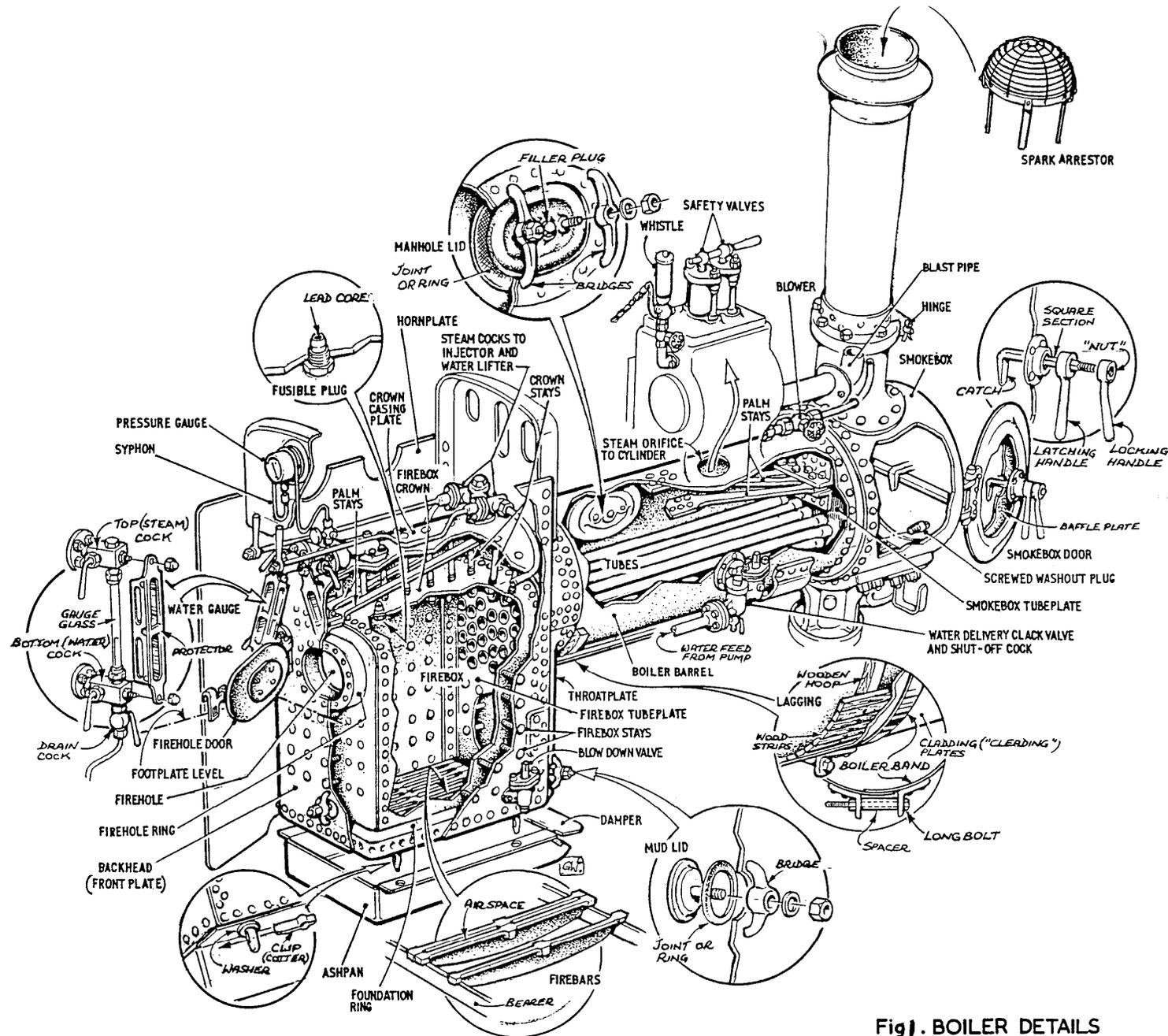
Fig. BOILER DETAILS
